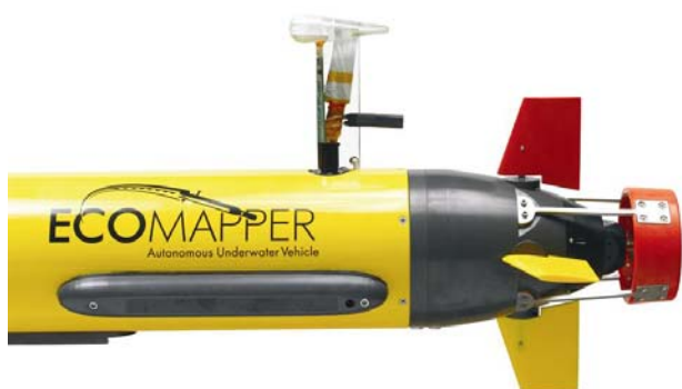
Fig. 5. sonar lateral (instalat pe ECOMAPPER) și exemplu de imagine scanată
