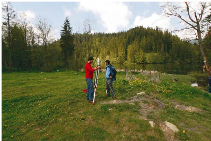
Fig. 2 Instalarea Stației Totale în vederea ridicării topografice a bazinului lacustru Roșu
